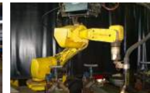
Robot de soldadura
