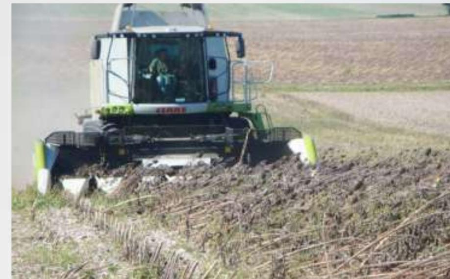
Der Schnitt wird mit einem Messerstern, der über ein weiteres Messer im hinteren Teil des Einzugs schneidet, ganz nah an der Doppeleinzugsschnecke durchgeführt.
