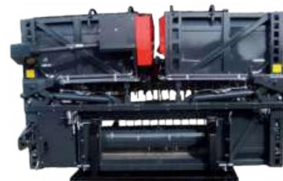
Grund der Einzugsschnecke aus Edelstahl zur Verbesserung des Gutflusses.
