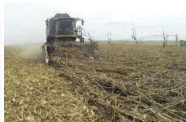
Oberhalb verlaufende Förderkette: Mit dieser Sonderausstattung kann Mais unter extremsten Bedingungen geerntet werden. Lagermais kann ganz einfach mit gleichmäßigem Einzug in den Vorsatz und hoher Mähdrescherleistung bei minimalem Kornverlust geerntet werden.
