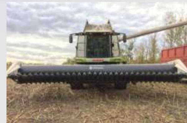
Dieses Modell wurde mit einer Abschirmung, die die Hubwinde abdeckt, sowie mit einer gekerbten Hubwinde unter der Auffangwanne ausgestattet, um die Zufuhr der Pflanzen zu verbessern. Sein Schild ist verstellbar, um eine bessere Anpassung an die Erntebedingungen zu erreichen, und unterstützt die Blumen dabei, das Schneidwerk in einer Position zu erreichen, in der nur die Blüten abgeschnitten werden und ein langer Stiel auf dem Feld verbleibt.
