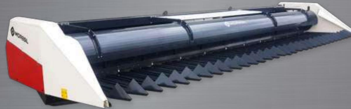
Das GBE-Modell ist eine Version des GB-Modells, die speziell für den Hochgeschwindigkeitseinsatz ohne Zerhacke entwickelt wurde, was eine höhere Effizienz bei der Reinigung ermöglicht. Die Hubwinde ist mit Schubteilen ausgestattet, um die Zufuhr zu verbessern und jegliche Anhäufung von Erntegut zu vermeiden.
