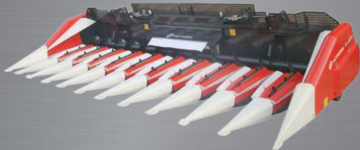
Die Förderketten des Modells G-4570 ermöglichen die Sonnenblumenernte unter extremen Bedingungen.
