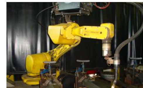
Robot de sudură
